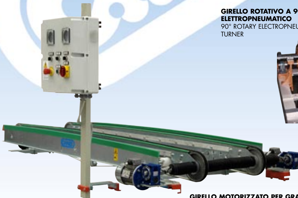
GIRELLO MOTORIZZATO PER GRANDI FORMATI AZIONATO DA INVERTER MOTORISED TILE TURNER FOR BIG SIZES POWERED BY INVERTER
