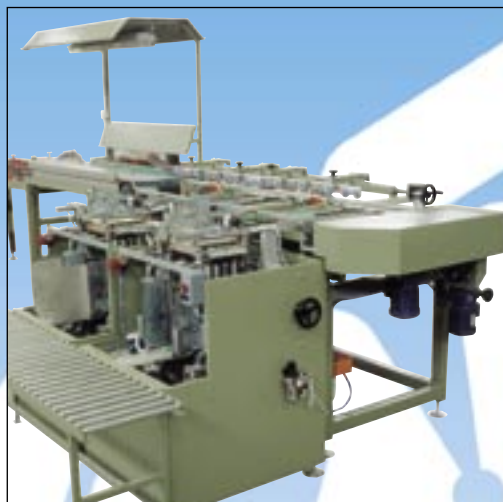
SCELTA SEMI-AUTOMATICA CON IMPILATORI MOD.F.40 SEMI-AUTOMATIC SORTING SYSTEM WITH STACKERS, MOD.F.40
