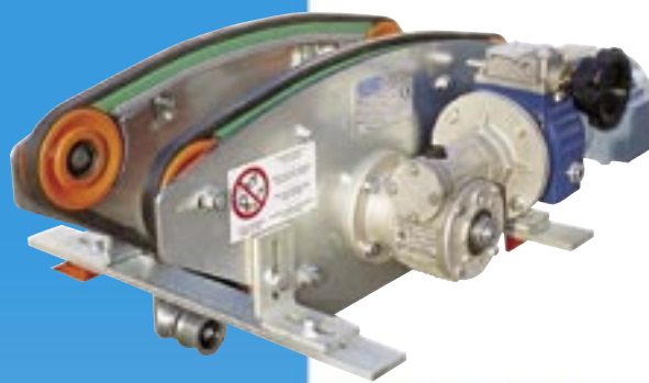
GIRELLO MOTORIZZATO 1 CINGHIA SU POLIZENE MOD.650 MOTORISED TILE TURNER WITH 1 BELT ON A POLYTHENE GUIDE, MOD.650
