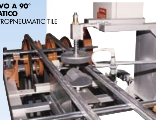
GIRELLO MOTORIZZATO A 1 C. SU POLIZENE MOD.1500 MOTORISED TILE TURNER WITH 1 BELT ON A POLYTHENE GUIDE, MOD.1500
