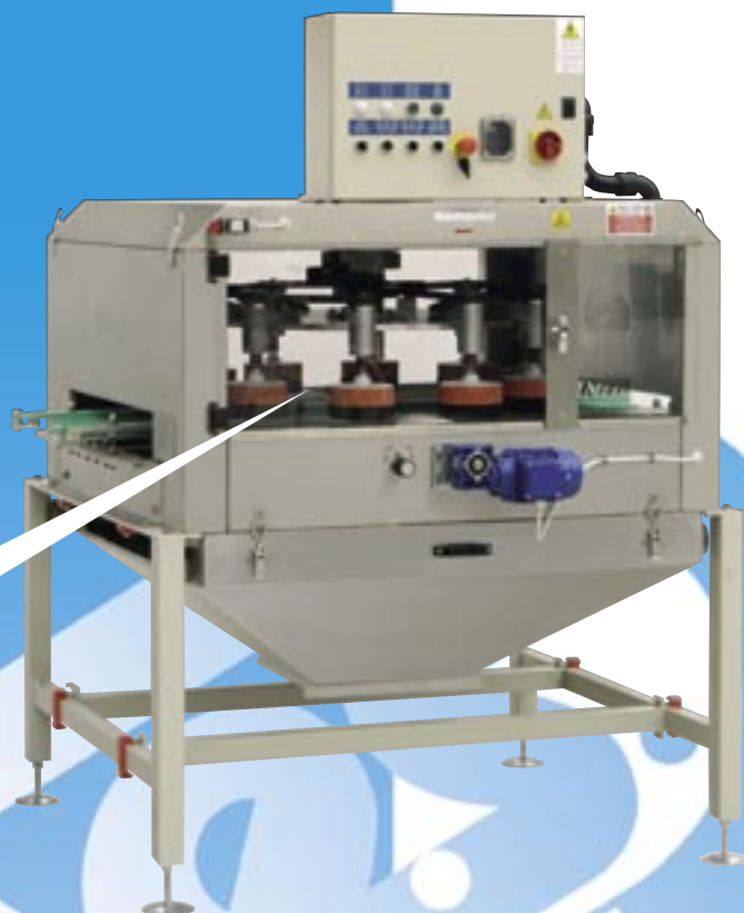
SPAZZOLATRICE AUTOMATICA PER EFFETTI RUSTICI MOD.F.40 AUTOMATIC BRUSHING MACHINE FOR RUSTIC EFFECTS, MOD.F.40
