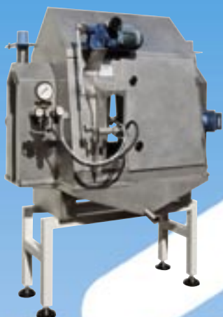
CABINA DI FIAMMATURA DOPPIA MOD.F.40 APPLICAZIONI IN VERTICALE DOUBLE FLASH EFFECT CABIN, MOD. F.40, FOR VERTICAL APPLICATION
