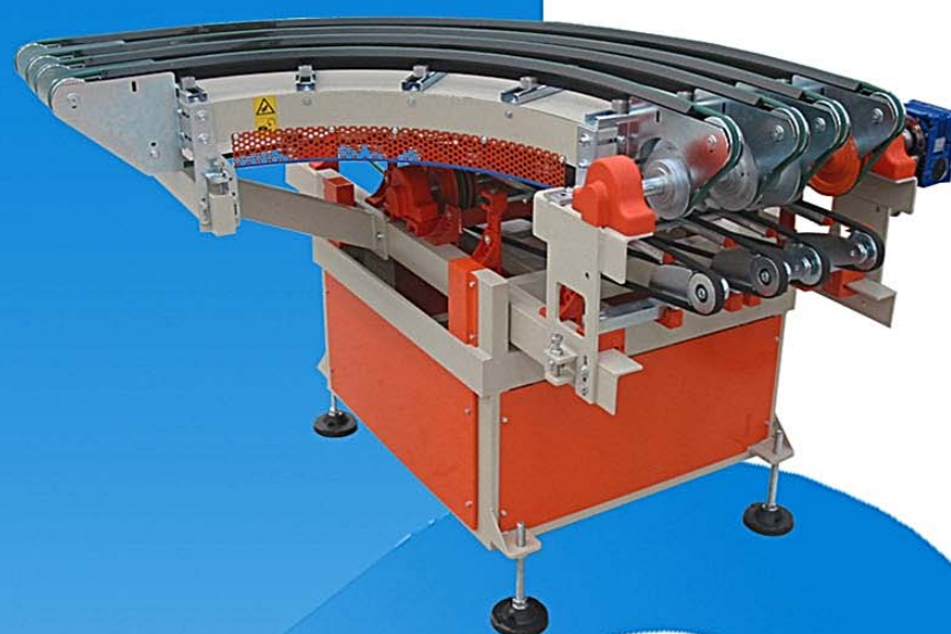
DEVIATORE DI LINEA A 2 VIE CON BY-PASS MOTORIZZATI E CURVA A 90° A SCOMPARSA CON SOLLEVAMENTO PNEUMATICO LINE DEFLECTING UNIT 2 WAYS WITH MOTORIZED BY-PASS AND CURVE AT 90° DISAPPEARANCE TYPE BY MEANS OF PNEUMATIC LIFTING
