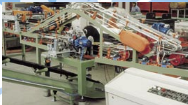
STACCATORE RIBALTATORE CONVOGLIATORE PER CLINKER MOD.F.40 DETACHING-TIPPER-CONVEYOR UNIT FOR CLINKER, MOD.F.40
