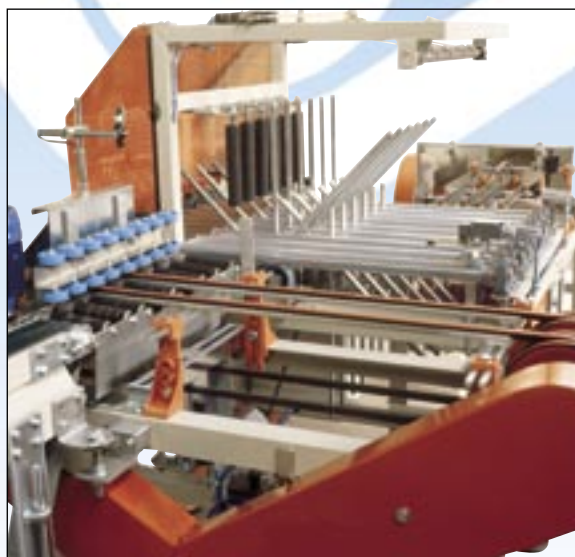
ALIMENTATORE A 90° CON RADDRIZZA PEZZI PER CLINKER MOD.F.40 90° FEEDER WITH PIECE STRAIGHTENER FOR CLINKER, MOD.F.40
