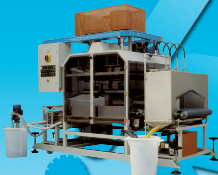
STAZIONE PER L' APPLICAZIONE DI SMALTO IN POLVERE A 2 COLORI SU MATERIALI ESTRUSI IN USCITA TRAFILA STATION FOR TWO-COLOR POWDER GLAZE APPLICATION FOR EXTRUDED MATERIALS IN DRAWBENCH OUTLET.
