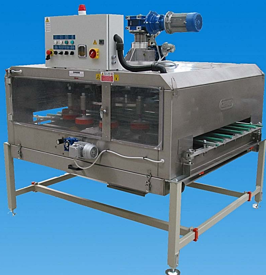
SPAZZOLATRICE AUTOMATICA PER EFFETTI RUSTICI MOD. F100 AUTOMATIC BRUSHING MACHINE FOR RUSTIC EFFECTS MOD. F100
