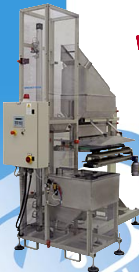
DISTRIBUTORE UNIVERSALE PER SMALTI A SECCO CON RICICLO GRAVITAZIONALE UNIVERSAL DISTRIBUTOR FOR DRY GLAZES WITH GRAVITATIONAL RECYCLING
