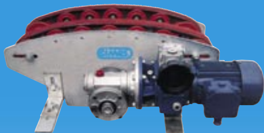
GIRELLO MOTORIZZATO A 2 CINGHIE SU ROTELLE MOD.650 MOTORISED TILE TURNER WITH 2 BELTS ON WHEELS, MOD.650
