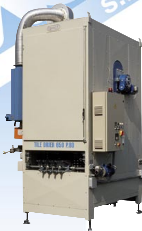
ALLUNGATORE DI LINEA VERTICALE TERMOVENTILATO 80/P MOD. F60 80/P THERMOVENTILATED VERTICAL LINE EXTENSION MOD.F.60
