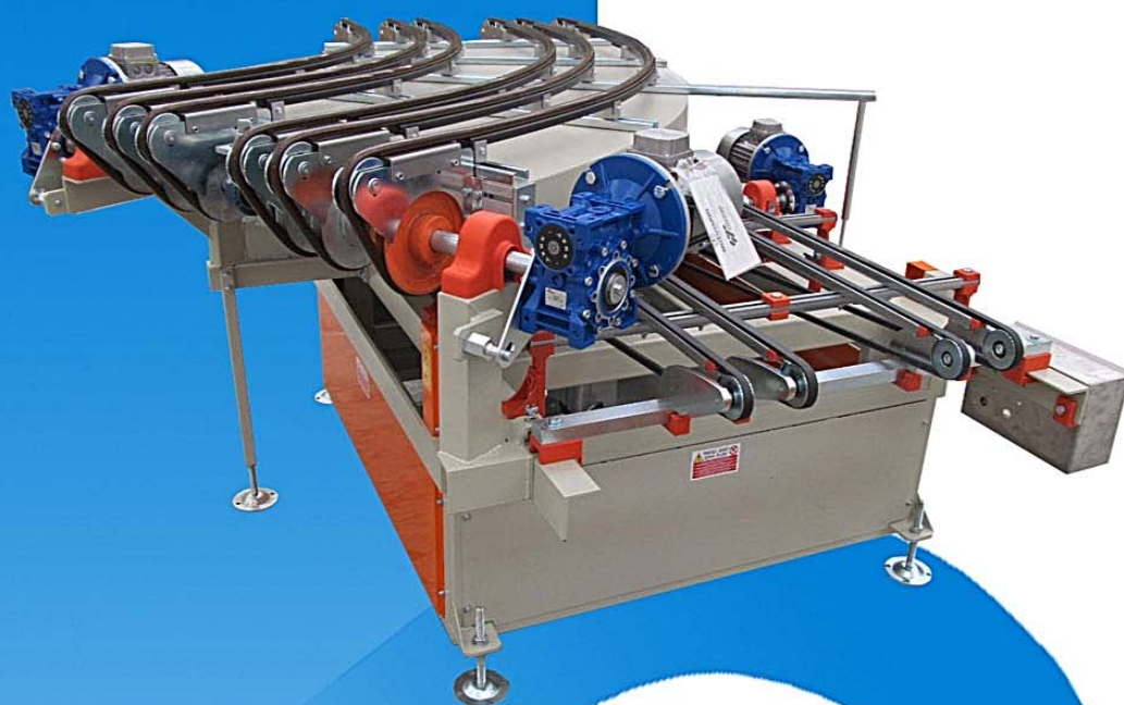
DEVIATORE DI LINEA A 2 VIE CON BY-PASS E CURVA 90° R=1500mm. A 90° A SCOMPARSA CON SOLLEVAMENTO PNEUMATICO MOTORIZZATI LINE'S DEFLECTING UNIT 2 WAYS WITH BY-PASS AND 90° CURVE R=1500mm. DISAPPEARANCE TYPE BY MEANS OF PNEUMATIC LIFTING
